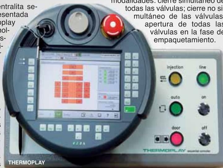
estándares técnico-cualitativos. La programación de la secuencia de moldeo puede realizarse en las siguientes modalidades: cierre simultáneo de todas las válvulas; cierre no simultáneo de las válvulas; apertura de todas las válvulas en la fase de empaquetamiento.
